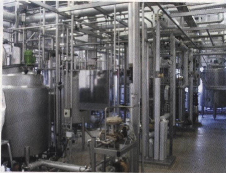
Hier erfolgt die Vorbereitung und Bearbeitung der Spezialmedien, die CSK zum Züchten seiner Kulturen verwendet
